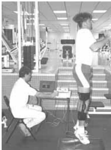
figure 8 : photo d'un test effectué avec le TAC. On repère l'ordinateur central qui indique la flexion du genou, le goniomètre fixé au genou de l'athlète et le tapis.
